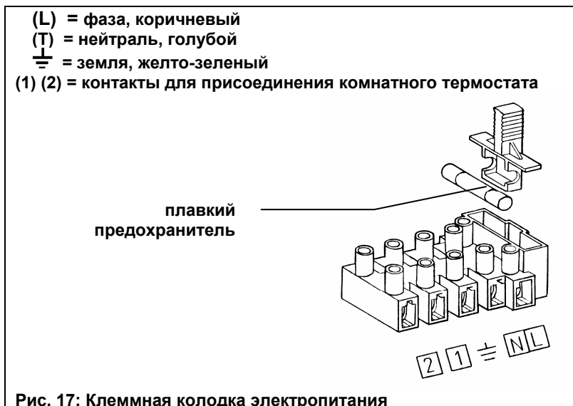
Рис. 17: Клеммная колодка электропитания
